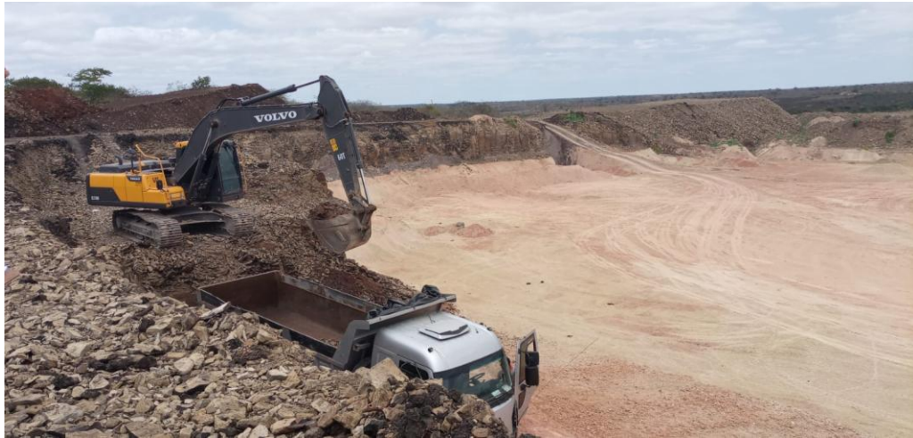
Figura 3 - Imagem das pás escavadeira colocando os rejeitos no caminhão para ser comercializado
