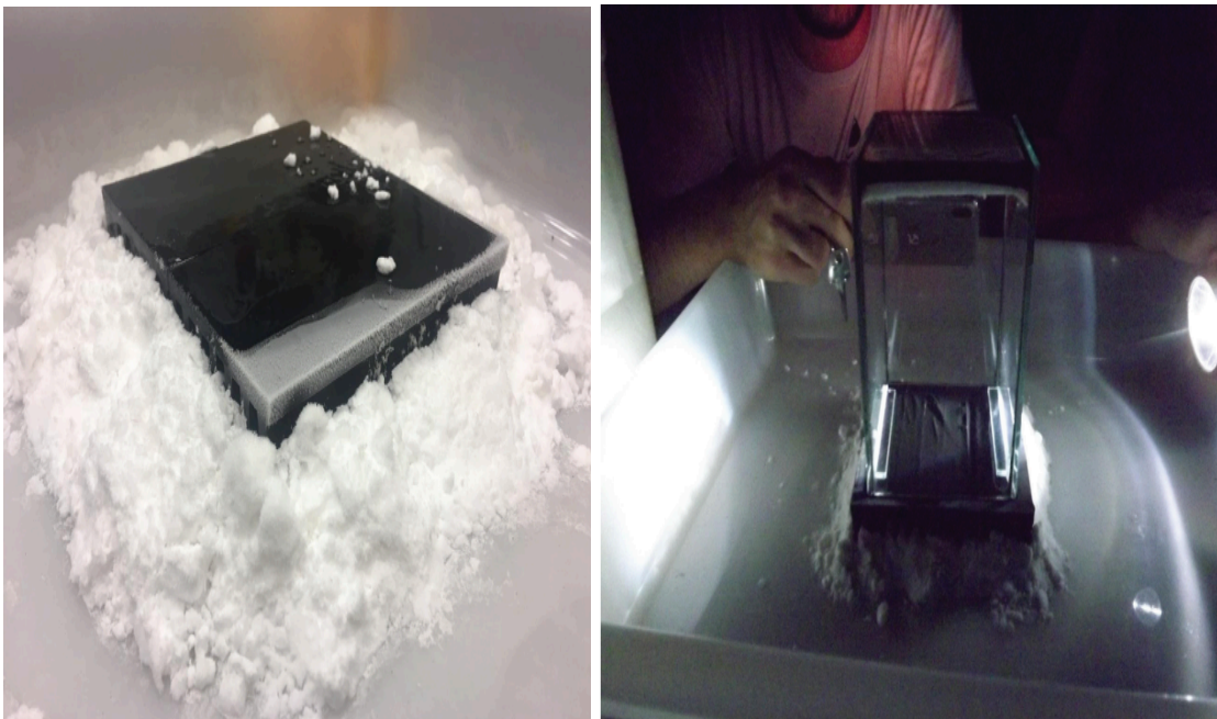
Figura 12: Gelo e dissipadores e a câmara de nuvens construída
