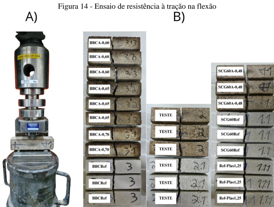
A) Corpo de prova posicionado na prensa para ruptura; B) Corpos de prova rompidos.
