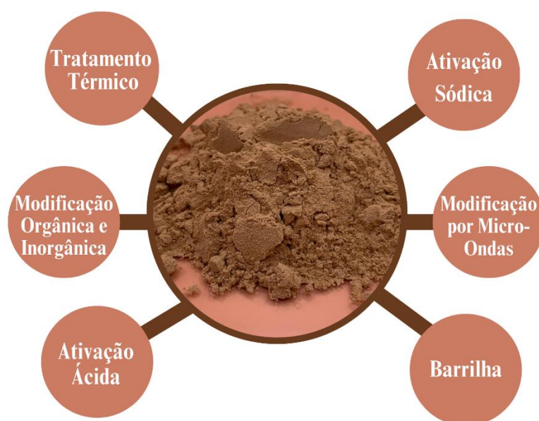
Figura 6. Esquemática dos métodos de ativação/modificação de argilominerais.
