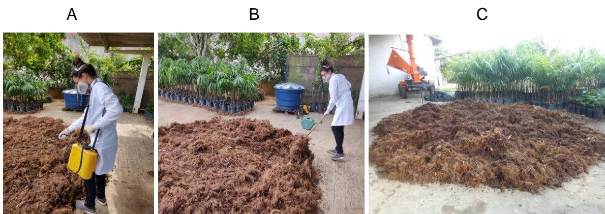
Figura 5: Aspersão de ácido nas cascas de coco seco trituradas.
