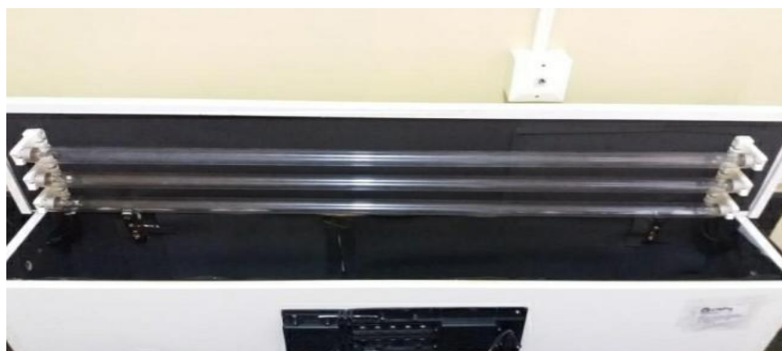
Figura 6 – Ilustração do fotoreator utilizado no teste fotocatalítico
