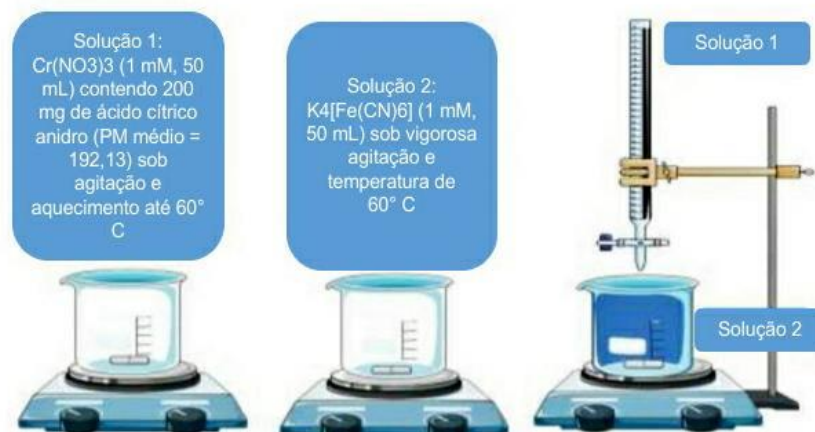
Figura 5 - Procedimento experimental da síntese de CrNPsAP
