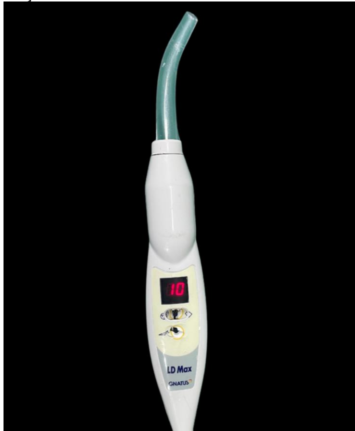
Imagem 3 – Fraturas nos botões do aparelho de fotopolimerização
