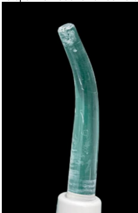
Imagem 2 – Fotopolimerizador exibindo fratura na ponteira
