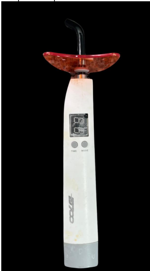
Imagem 4 – Display com fratura e sem funcionamento, além de sujidades no corpo do fotopolimerizador
