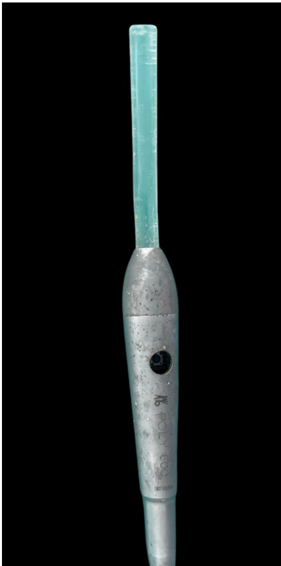
Imagem 5 – Fotopolimerizador com manchas, sujidades e ausência de botão de acionamento
