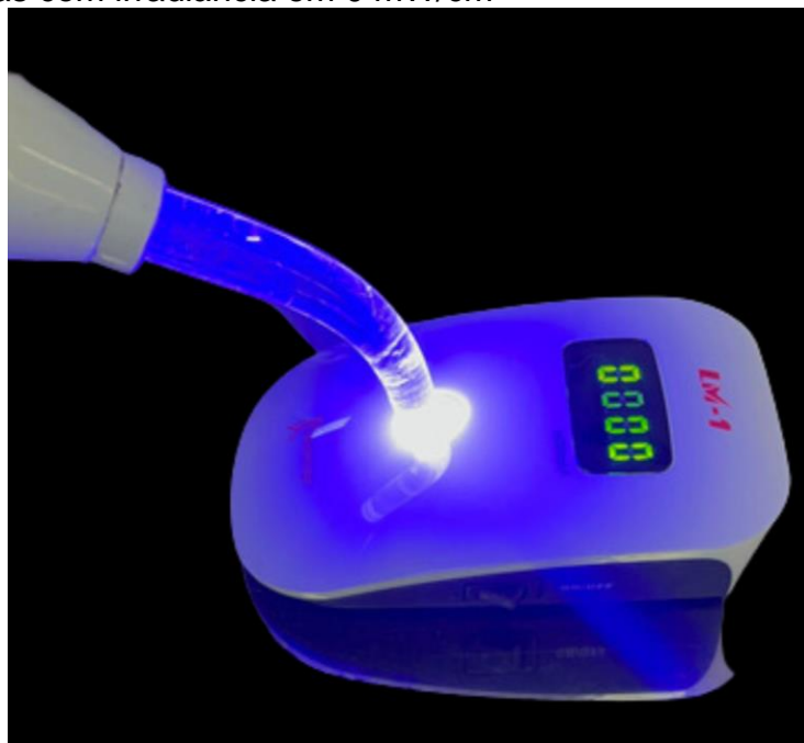
Imagem 1 – Exemplo de fotopolimerizador exibindo emissão de luz, mas com irradiância em 0 mW/cm 2
