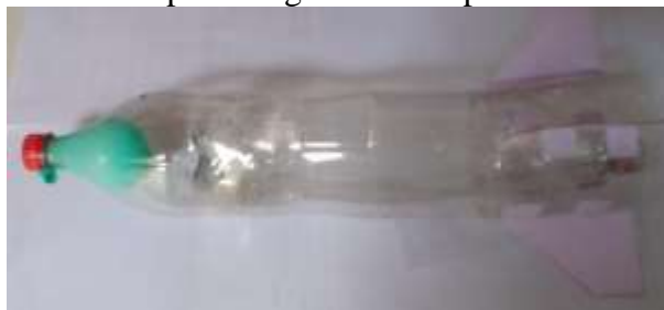
Figura 7 - Una o corpo do foguete com a parte das aletas com fita.
