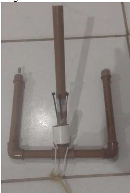
Figura 16 - Armação do gatilho com o cano branco de 4 cm de comprimento.
