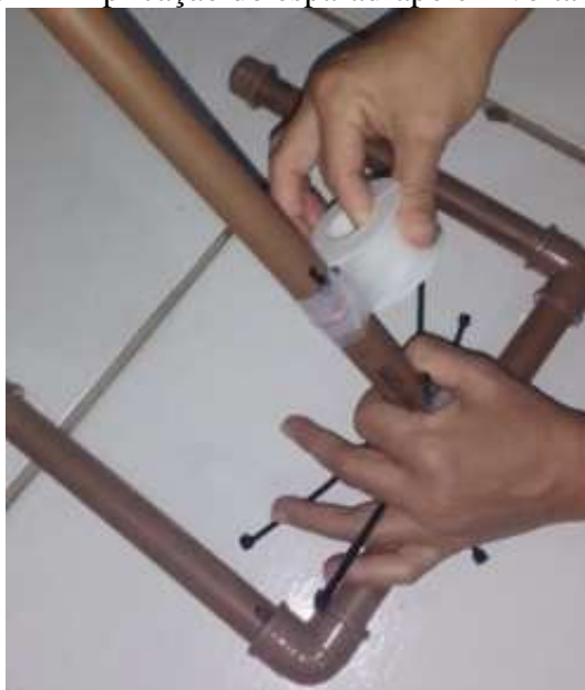
Figura 14 - Aplicação do esparadrapo em volta do anel.
