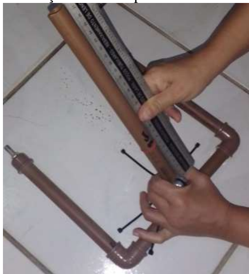
Figura 13 - Fixação do anel a partir de 8 cm da conexão T.
