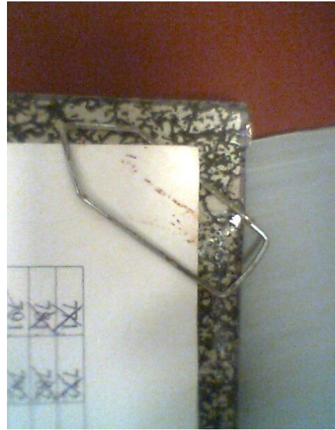
FIGURA 30: Oxidação de material metálico FONTE: Dados da pesquisa (2010)
