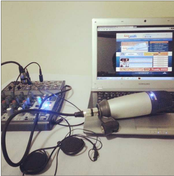
Detalhe dos equipamentos utilizados para as transmissões: mesa de som, fone de ouvido, microfone profissional e notebook conectado à internet.
