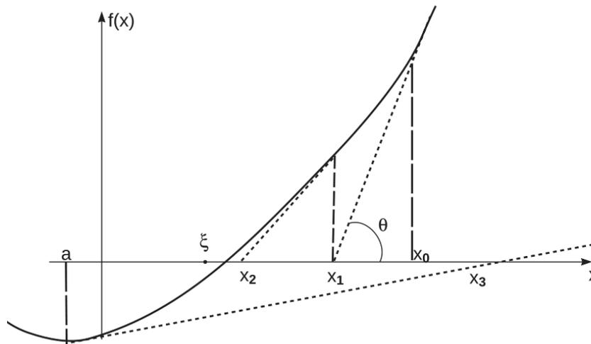
Figura 2.3.1: Representação do Método de Newton, retas tangentes a curva da função  $f(x)$ .
