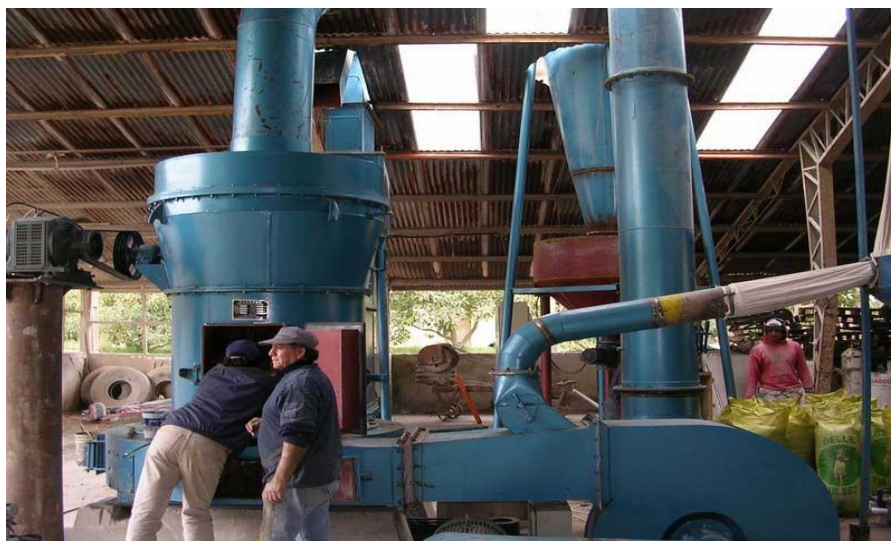
Figura 6: Moinho Vertical com Pêndulos.
