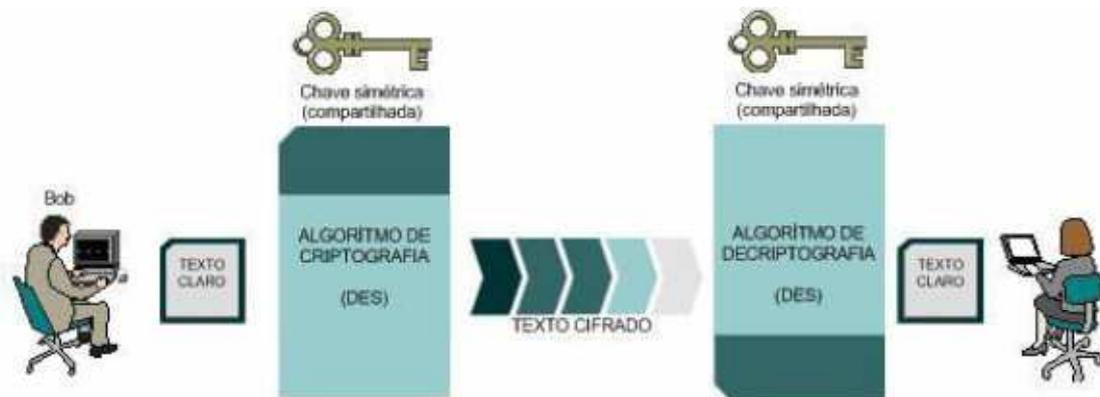
**Figura 1** - Exemplo de algoritmo simétrico
