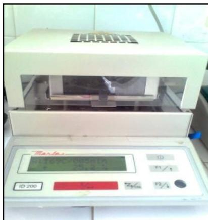
Figura 2 - Determinador de umidade por infra-vermelho. Foto: Apolinário, A.C. (2010)
