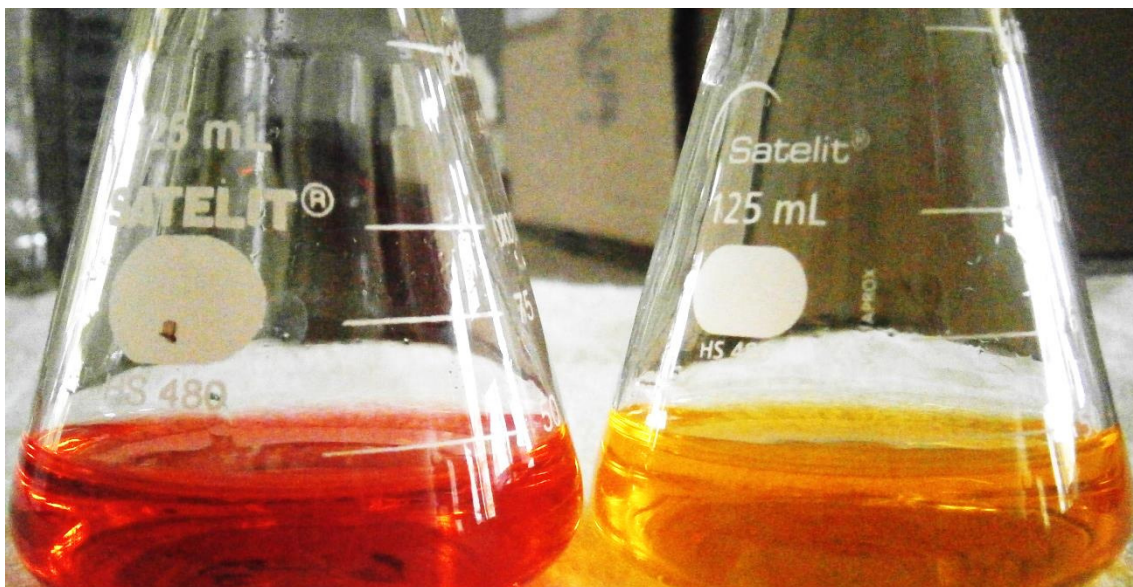
FIGURA 3: Amostra da água após (direita) e antes (esquerda) da titulação de neutralização, para determinação da Alcalinidade total.
