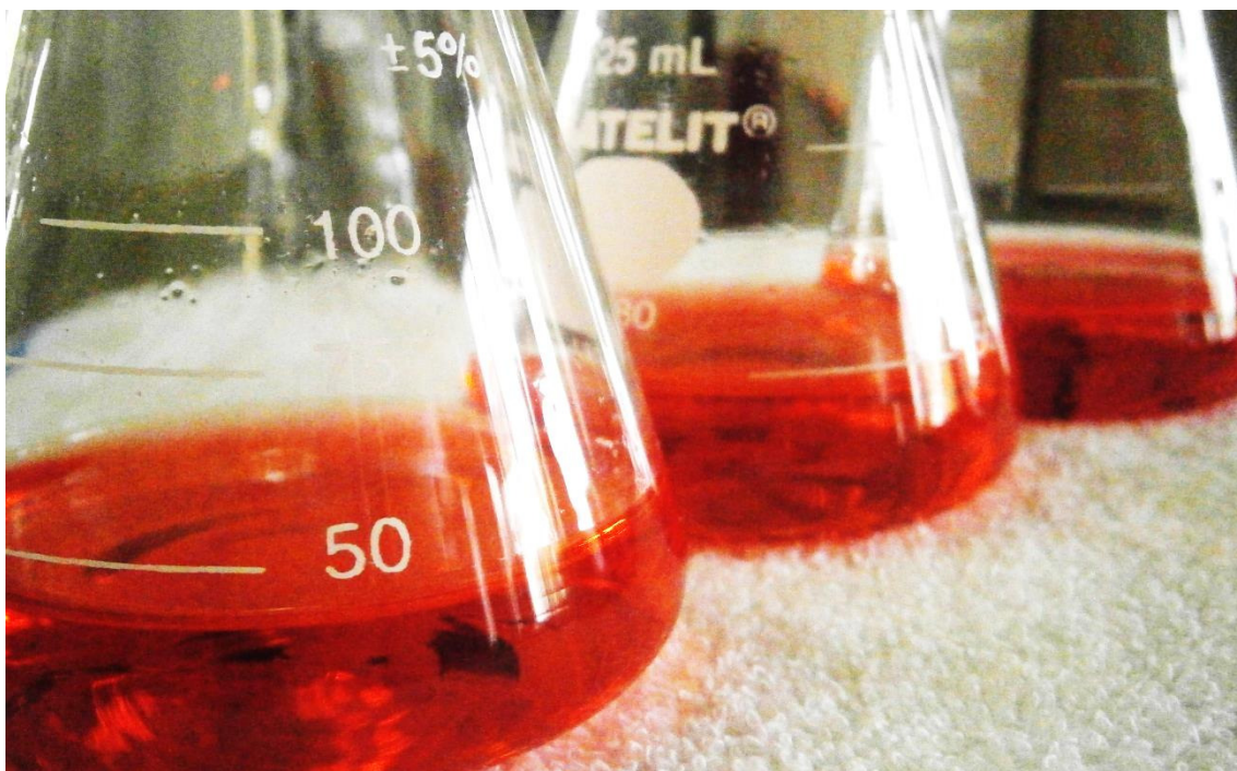
FIGURA 4: Amostras em triplicata após procedimento analítico de determinação da alcalinidade total.
