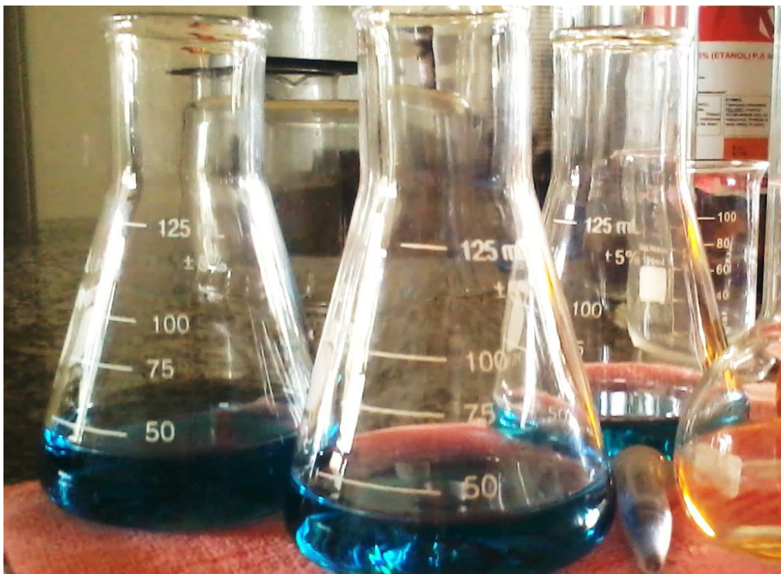
FIGURA 6: Amostras em triplicata da água após procedimento analítico de determinação da dureza total.
