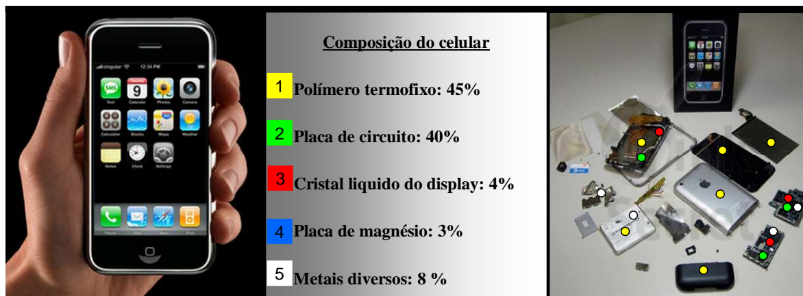
Figura 4 – Celular desmontado e seus principais componentes
