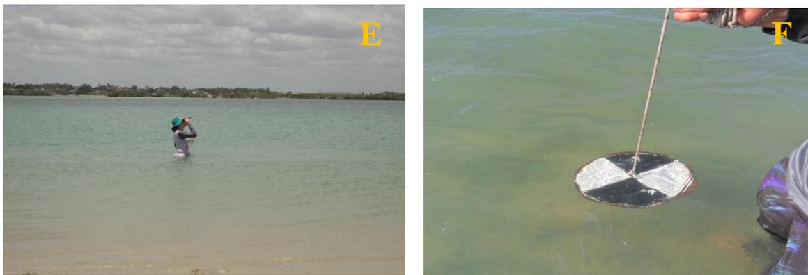
**Figura 4 – Trabalho de campo: A – Rede picaré; B – Arrasto; C – Captura dos peixes; D – Aferição da temperatura da água com termômetro; E – Aferição da salinidade da água com o refratômetro; F – Aferição da Transparência e Profundidade com o disco de Secchi. Fotos: Ronnie Oliveira© 2012 (A), André Pessanha© 2012 (B), Antônio Limeira© 2012(C), Natalice Santos© 2012 (D,F) e Gabriela Figueiredo© 2012 (E).**
