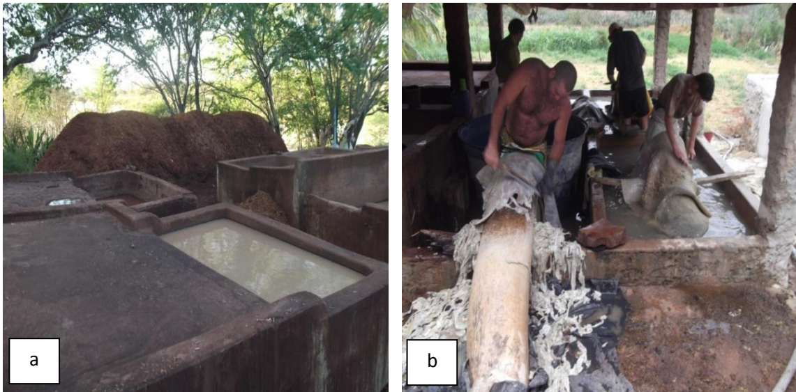
Figura 8. Tanque de caleiro (a), remoção de carnes e gorduras da parte interna da pele (b).
