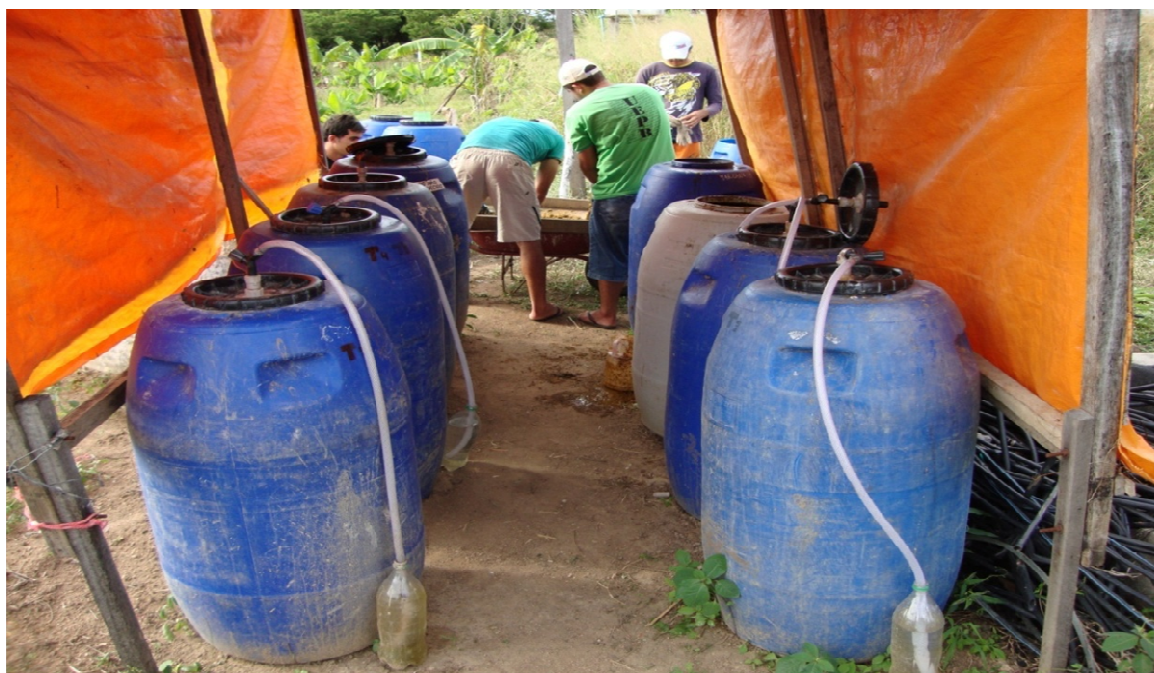
Figura 4. Esquema prático de montagem de um biodigestor para produção de biofertilizantes, Catolé do Rocha/PB, 2013.
