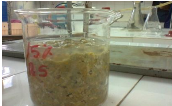
FIGURA 17: Amostra da areia sanitária (AS3) incorporada com 15% de lama abrasiva após o teste do com gotejamento rápido (tipo jatos d'água).
