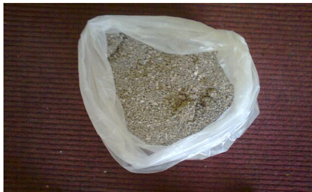
FIGURA 6: Areia sanitária padrão, produzida com 70% da sua composição de bentonita e 30% de argila branca.
