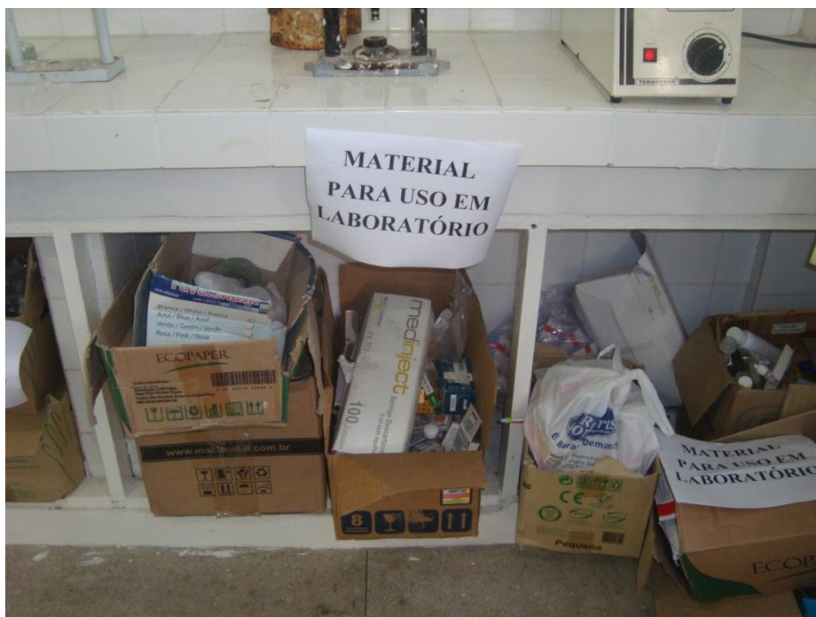
Figura 7: Armazenamento inadequado de produtos químicos.
