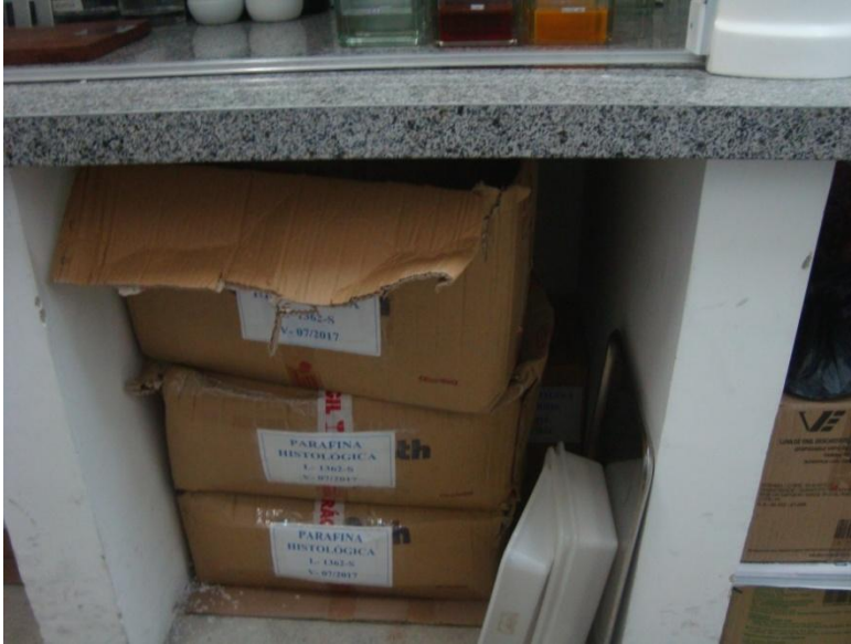
Figura 15: Substâncias químicas armazenadas de forma inadequada, em caixas de papelão no chão.
