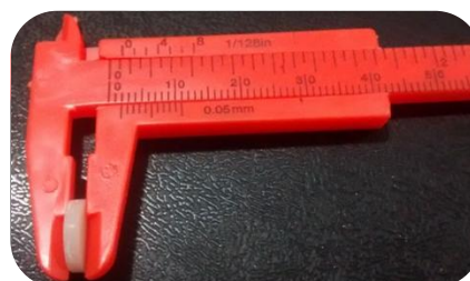
Fig.3- Medição da espessura
