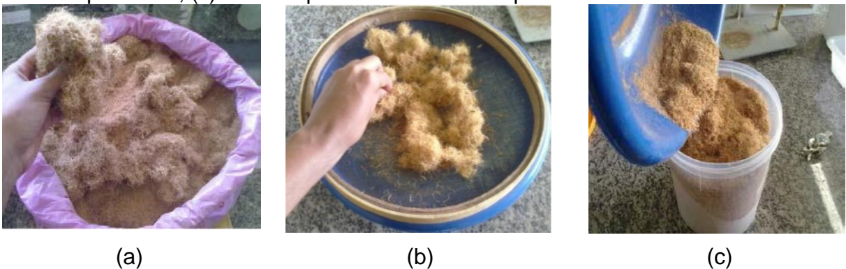
Figura 4 – (a) Mesocarpo do coco após ser moído na forrageira; (b) Peneiramento do mesocarpo moído; (c) Mesocarpo de coco na forma particulada.
