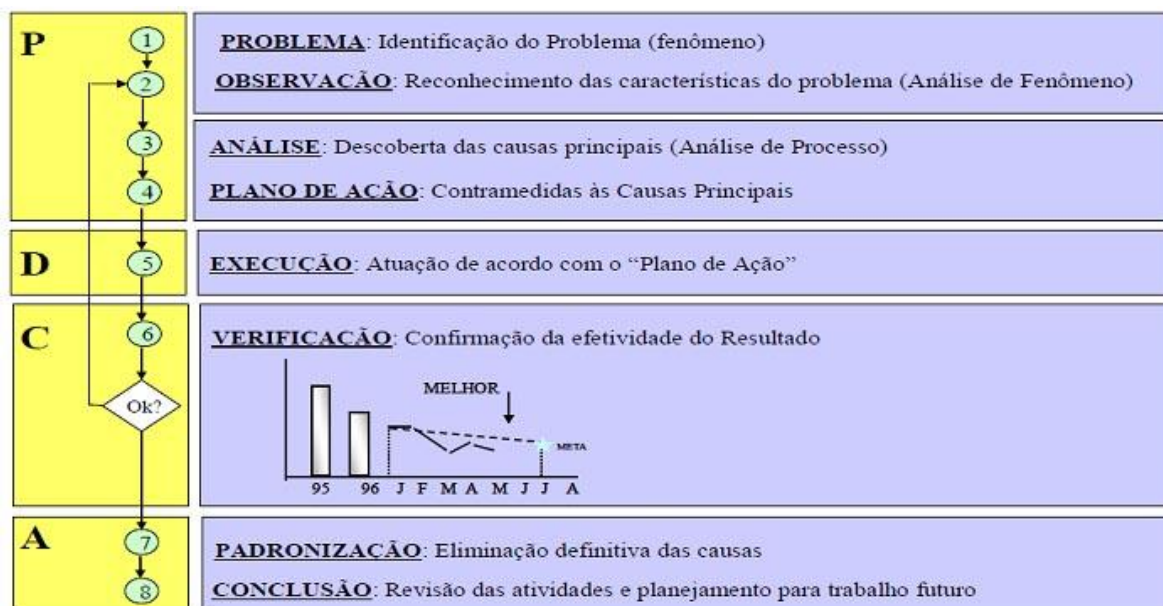
Figura 2: Forma genérica do ciclo PDCA, com os oito passos detalhados
