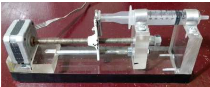
Figura 6 – Protótipo de mecanismo de infusão tipo seringa
