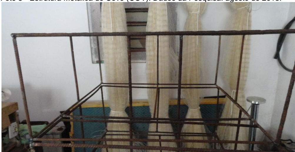
Foto 3 - Estrutura Metálica do Covo (COV). Dados da Pesquisa: agosto de 2013.
