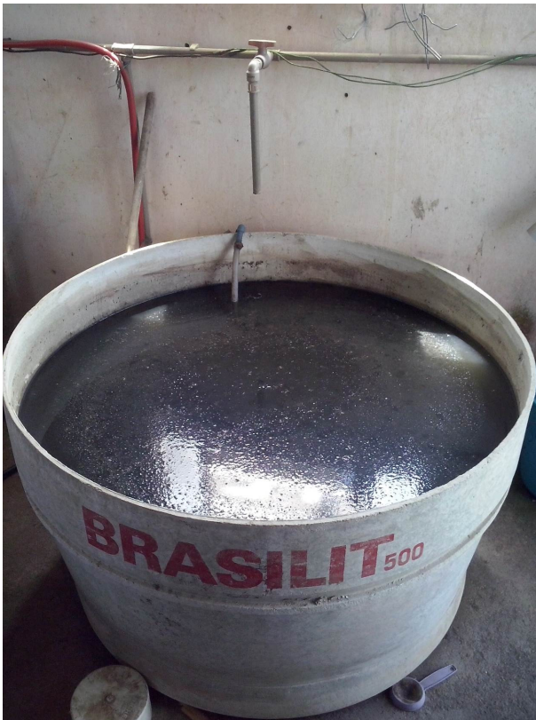
Figura 3 - Reservatório abastecido com 98% de Esgoto Doméstico e 2% de Lixiviado de Aterro Sanitário
