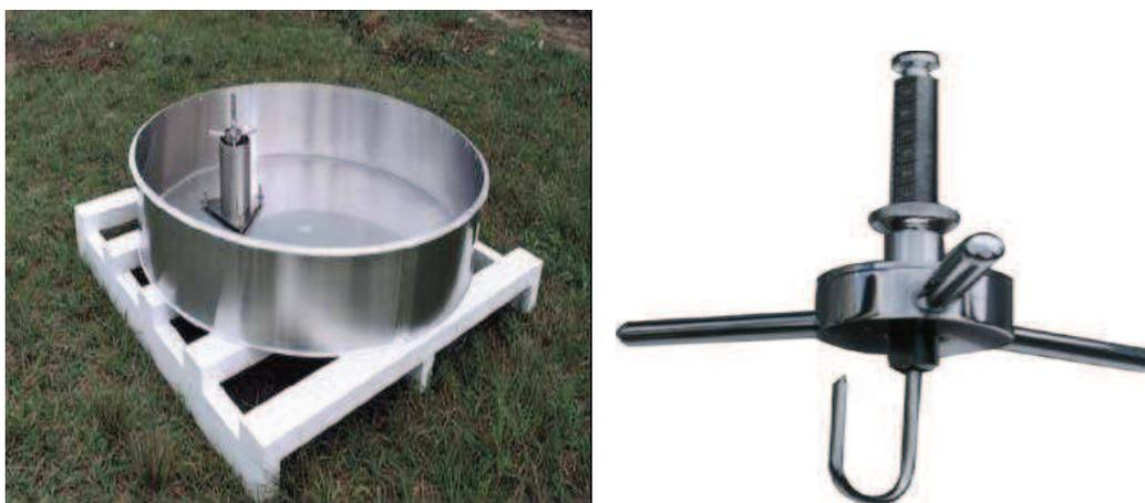
**Figura 2.** Tanque de evaporação Classe A e parafuso micrométrico. Fontes: [www.google.com.br/images](http://www.google.com.br/images).
