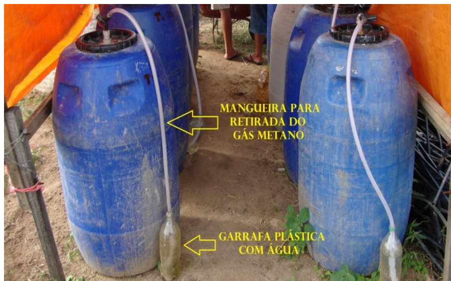
Figura 4. Biodigestores formados de bombonas plásticas para obtenção de biofertilizantes. Estação Experimental Agroecológica, Campus IV da UEPB, Catolé do Rocha -PB.
