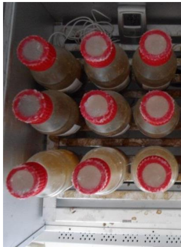
Figura 2: Reatores submetidos a temperatura controlada em estufa
