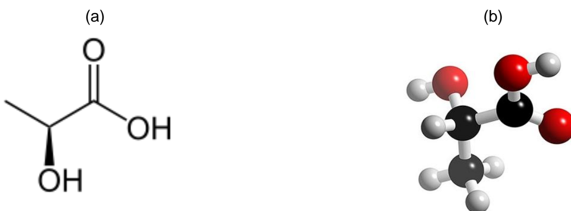
Figura 3: Estrutura do ácido láctico (ácido 2-hidróxi-propanóico) (a) estrutura em linha e (b) modelo de bolas
