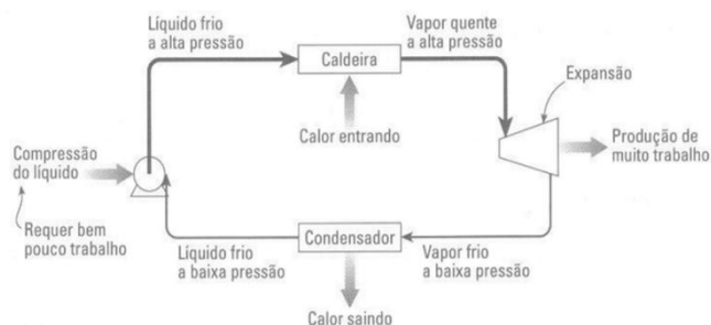
Figura 1: Esquema do dispositivo Ciclo G-L Fechado.
