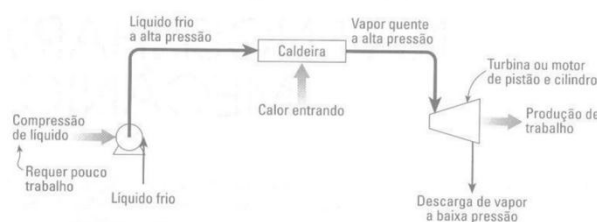
Figura 2: Esquema do dispositivo de único passe G-L, ciclo aberto.
