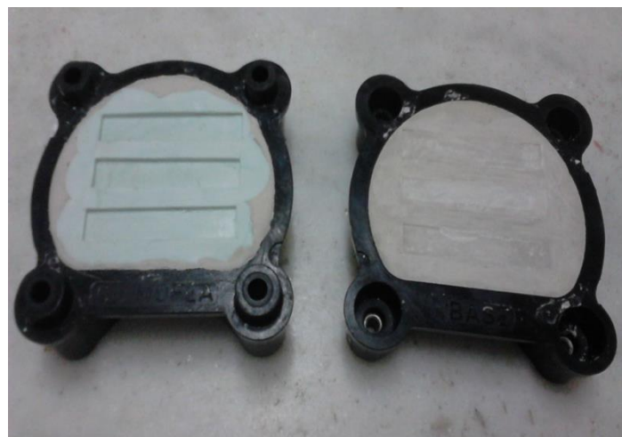
Figura 11. Base e contra-mufla com o molde das matrizes
