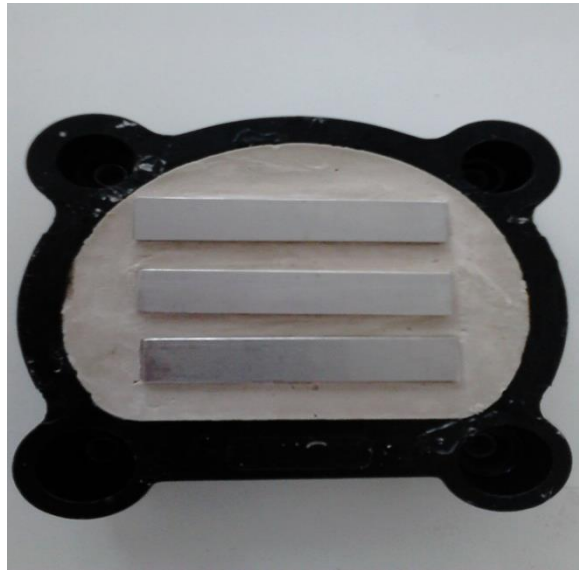
Figura 8. Inclusão das matrizes metálicas em muflas para microondas
