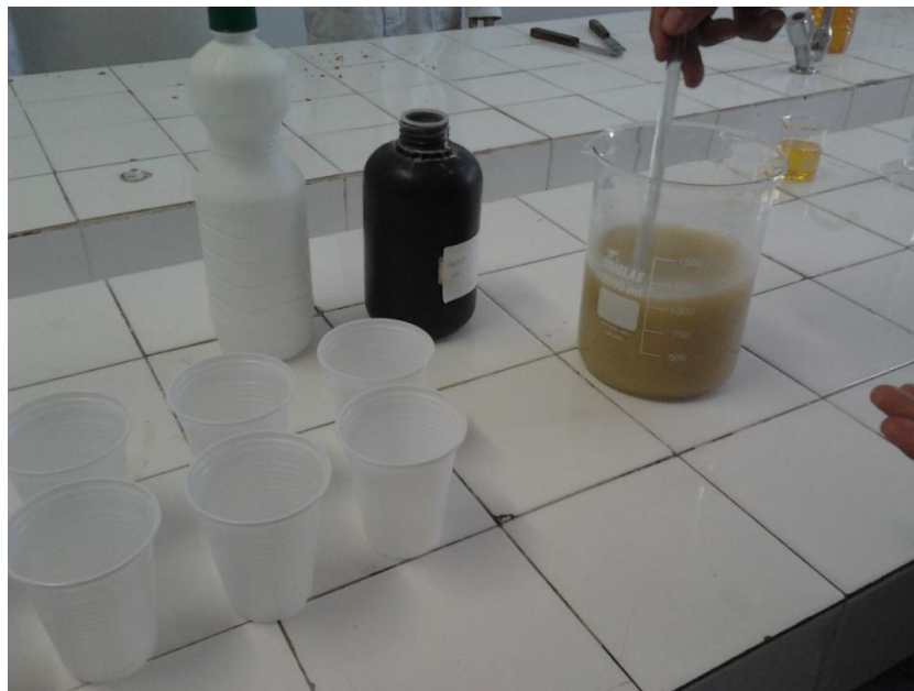
FIGURA 9 - Reação do óleo com hidróxido de sódio a 40%.
