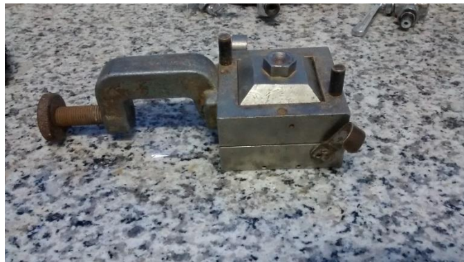
Figura 5 - Caixa bipartida dotada de placas dentadas e perfuradas, pedras porosas de topo e base e quepe para transmissão de carga.
