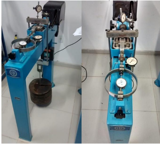
Figura 6 - Prensa equipada com motor e sistema de transmissão de carga pendural.
