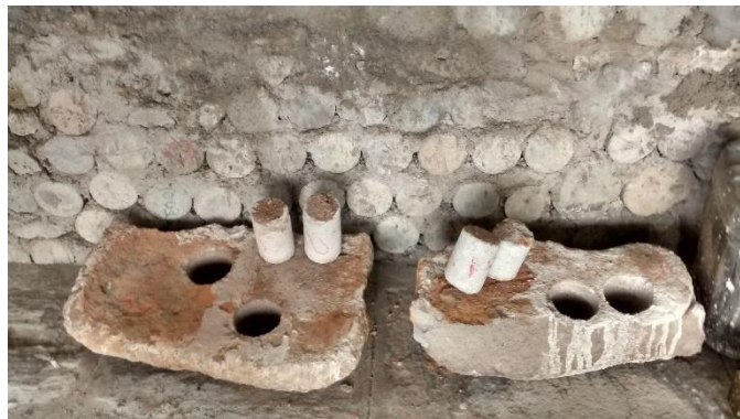
Figura 11 - Amostra indeformada de solo-cimento.
