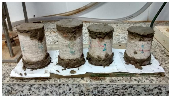
Figura 12 - Regularização das faces das amostras para realização do ensaio.
