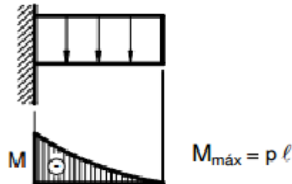
Figura 08 - Laje em balanço armada em uma direção.
