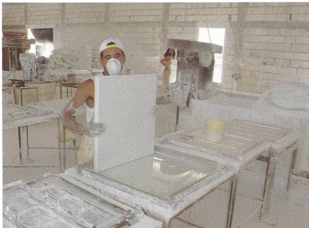
FIGURA 02: Fabricação de placas de gesso
