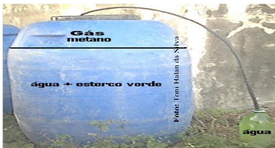
Figura 1. Ilustração do processo de produção do biofertilizante enriquecido.
