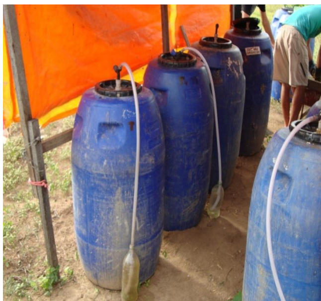
Figura 1. Produção anaeróbia de biofertilizantes em biodigestores (bombonas). UEPB, Catolé do Rocha-PB. 2011.
