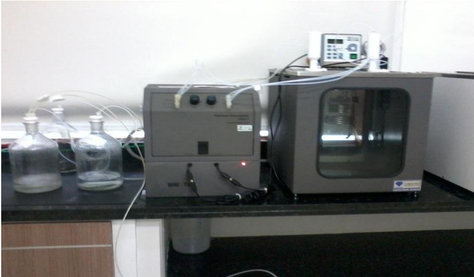
**Figura 5.** Viscosímetro RHEOTEK RPV-1 PULP
