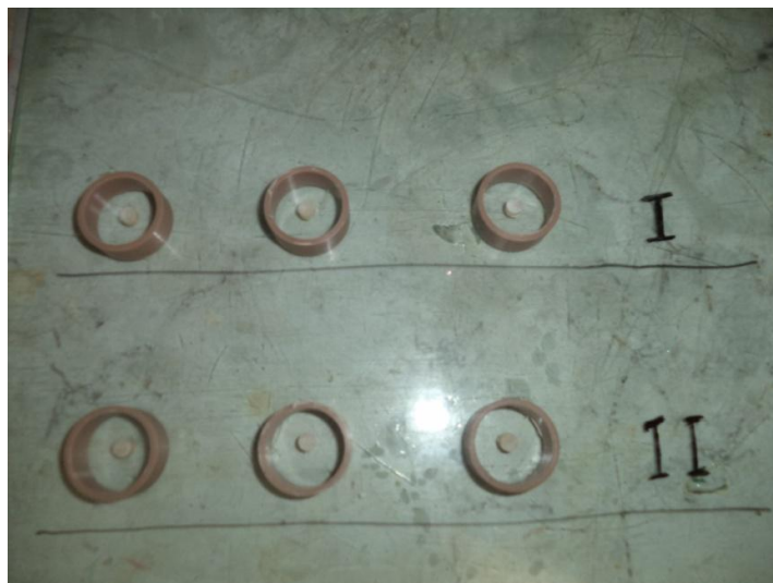
Figura 9 – Posicionamento dos espécimes e dos anéis de PVC para receberem a resina duralay
