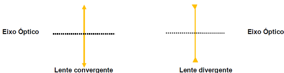
Figura 10: Representação esquemática das lentes convergentes e divergentes.
