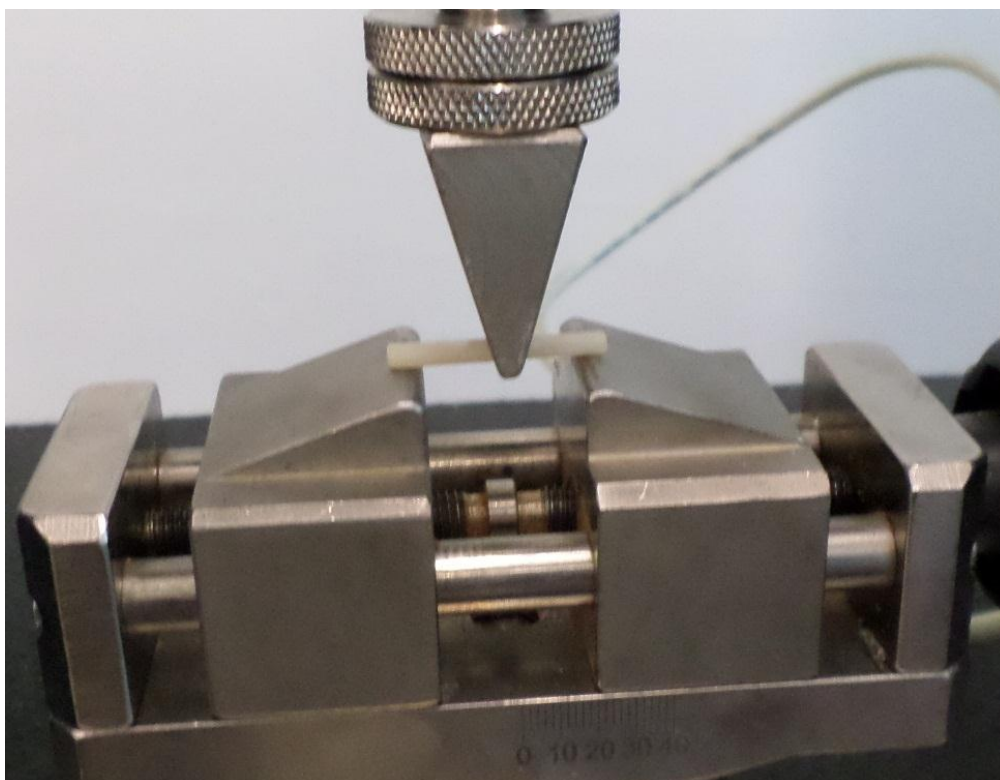
Figura 9 - Espécime na máquina para o teste de resistência à flexão
