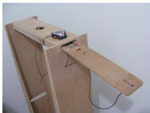
Figura V – Ligação do cronometro aos elementos de madeira do aparato experimental.
