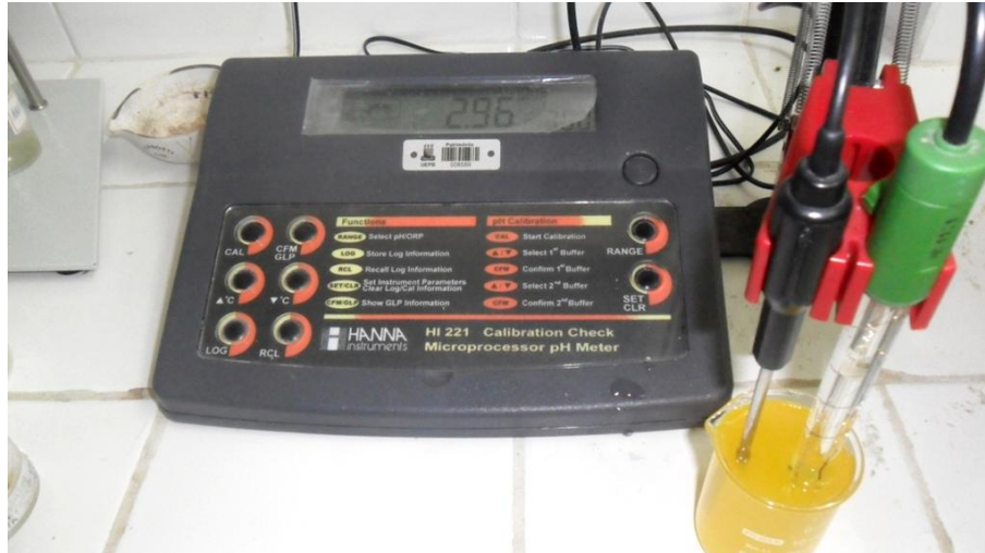
Figura 2. Mensuração do pH das bebidas analisadas.
