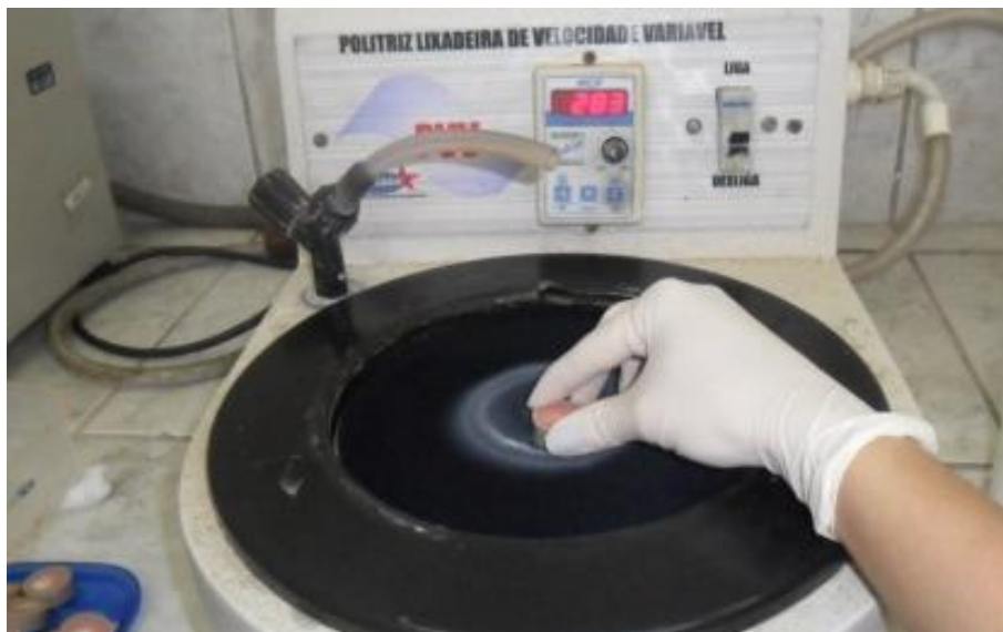
Figura 6. Polimento dos corpos de prova.
