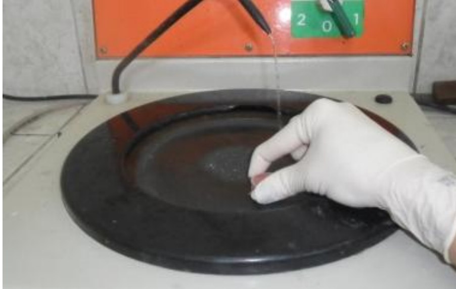
Figura 5. Lixamento dos corpos de prova.
