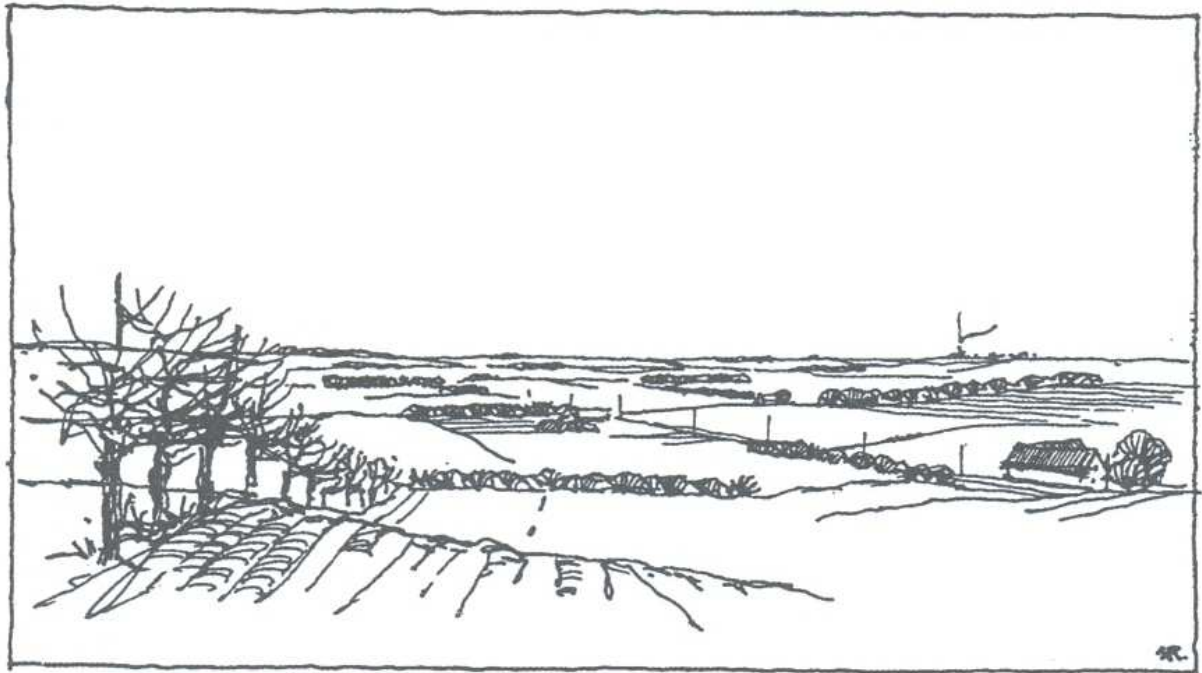
Figura 3. 5: Exemplo de terreno com rugosidade classe 2 ( Z_0=0,1\text{m} ). (Fonte: Custódio, 2007)
