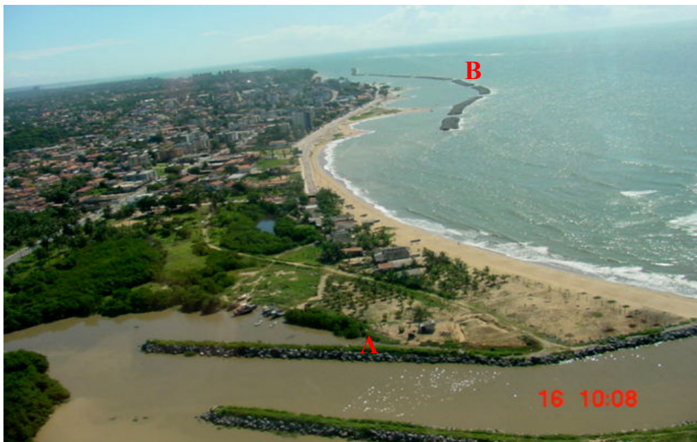
Figura 4 – Guia corrente (A) na foz da bacia do rio Paratibe e quebra-mares (B), na praia do Janga.
