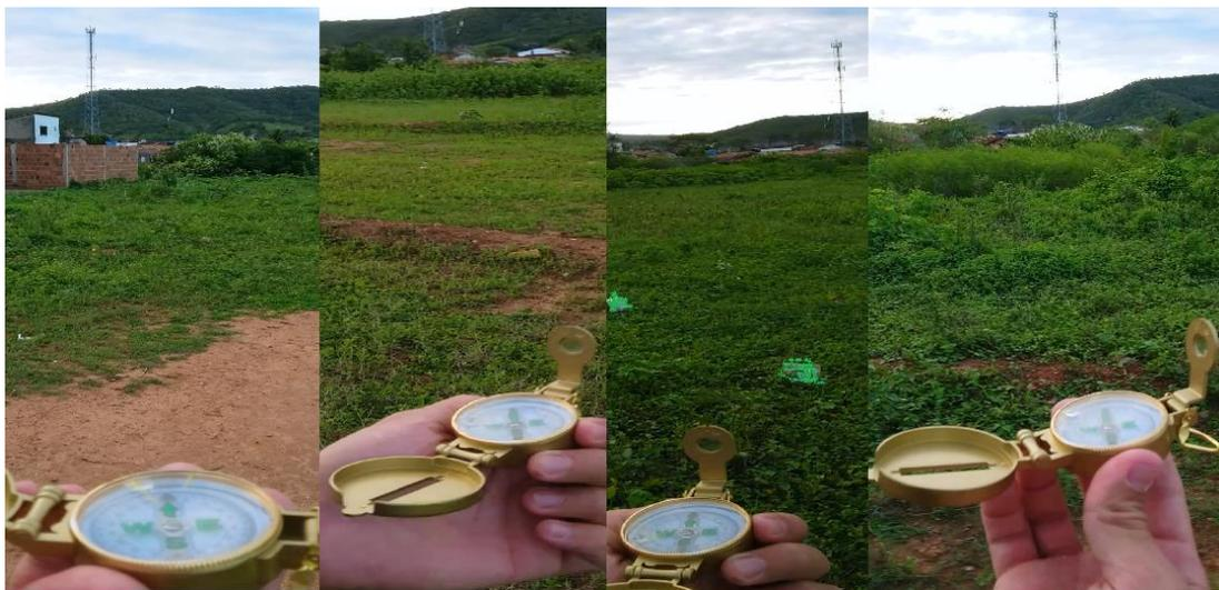
Figura 10: Agulha da bússola sendo atraída pela torre de telefonia no local onde foi realizado o experimento.
