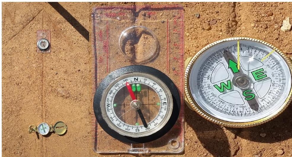
Figura 9: Bússola posicionada e alinhada exatamente com o norte apontado pelo experimento tendo resultado de  $20^\circ$  de diferença entre o norte-sul verdadeiro e o norte-sul magnético.
