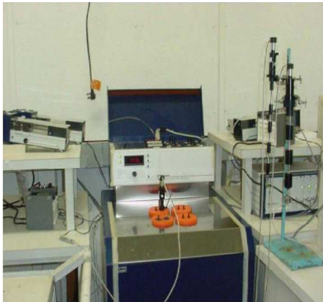
Figura 4 – Micro calorímetro Isotérmico de Condução de Calor LKB 2277 Fonte: figura da tese de doutorado do Dr. Ilauro de Souza Lima
