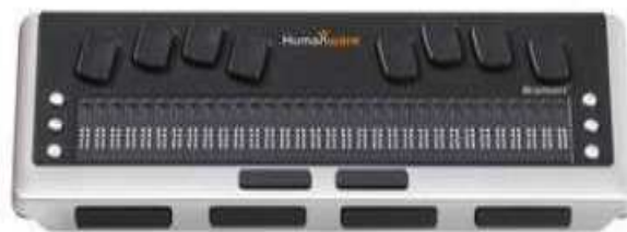
Figura 6 – Display Braille portátil
