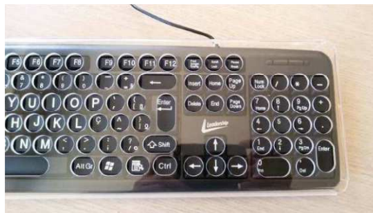
Figura 1 – Colmeia acoplada a um teclado convencional
